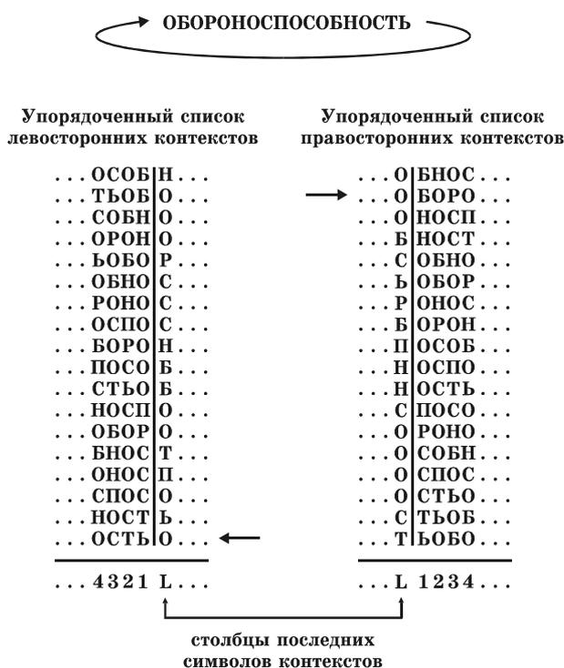
Рис. 5.19. Преобразование Барроуза-Уилера
