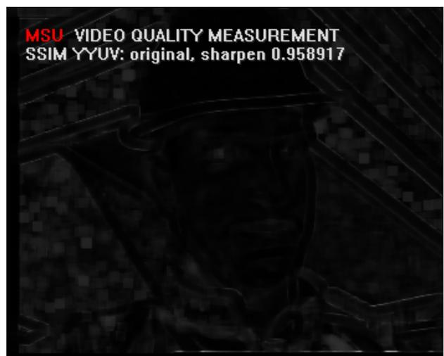
(d) SSIM map for sharpen image, **SSIM = 0.958917**
