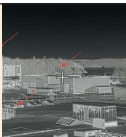
Технология DDE: цифровое улучшение детализации изображения для тепловизоров
